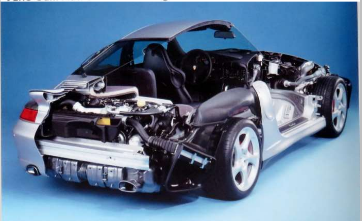
Das 3,6-Liter-Aggregat mit zwei parallel geschalteten Turboladern sowie Vario Cam Plus: ein absolutes High-Tech-Triebwerk.
