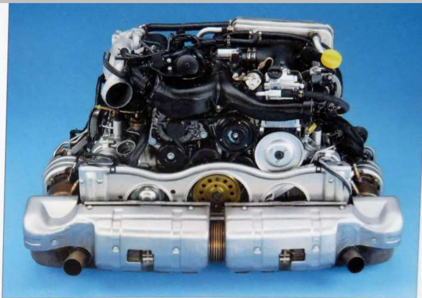
Das 3,6-Liter-Aggregat mit zwei parallel geschalteten Turboladern sowie Vario Cam Plus: ein absolutes High-Tech-Triebwerk.
