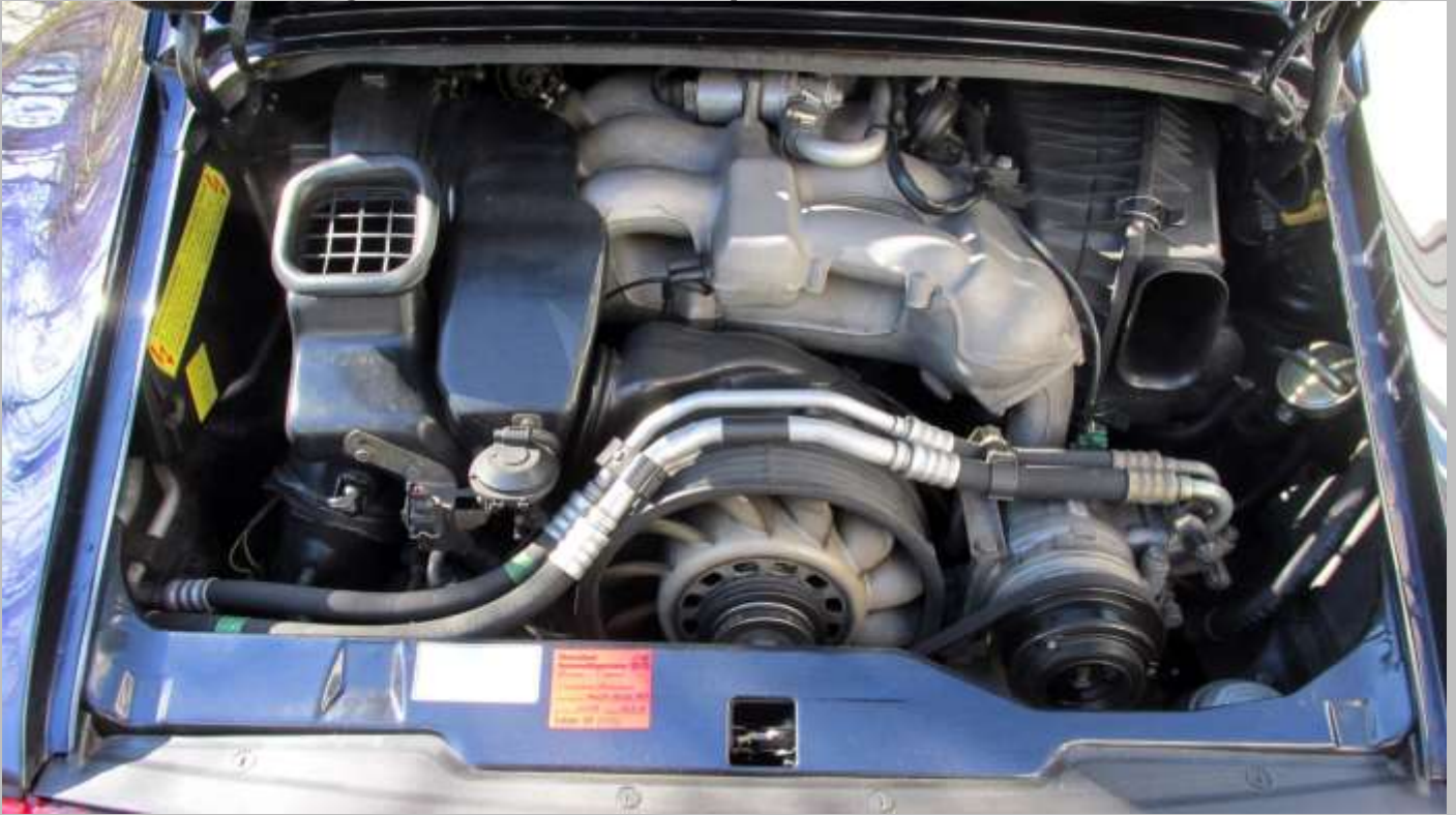
1996: Motor der letzten Stufe mit Varioram , 285 PS
