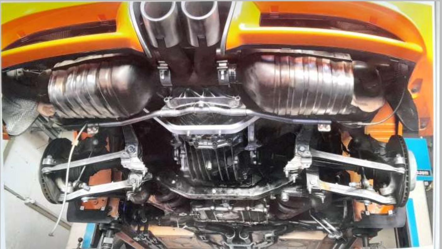
Der Motor / Getriebe / Abgasanlage ohne die Unterbodenverkleidung .
