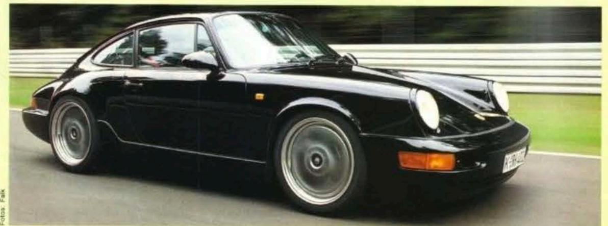
Da sich alle Einfälle mehr oder weniger unter dem Blech des RS verstecken, leisten die gewählten Felgen den größten Beitrag zur Öffentlichkeitsarbeit des Wagens. Hier machen sich 18-Zoll-Leichtmetallräder im Design von Vittorio Strosek in den Radhäusern breit, eine Wahl, die laut Motorenmann Harry Weishaupt auch nach Überlegungen zur Fahrdynamik erfolgte: „Mit den 18-Zöllern wird die Gesamtübersetzung des Wagens ein wenig länger. Das sollte gut zum Drehmomentverlauf unseres Motors passen.“
